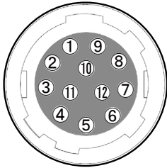
그림 7-3 전원 입력 및 컨트롤 입/출력 단자의 핀 배치도
