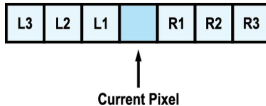
Figure 10-7 보정할 Defect Pixel의 위치
