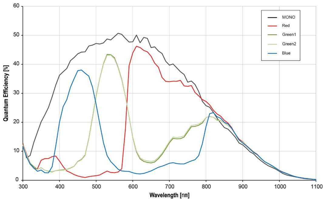
Figure 5.4 VC-25MX-81 D 흑백 및 컬러 Spectral Response
