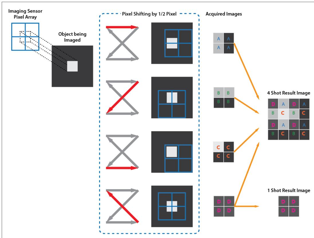
Figure 9.11 Pixel Shifting 출력 영상과 기본 영상과의 비교
