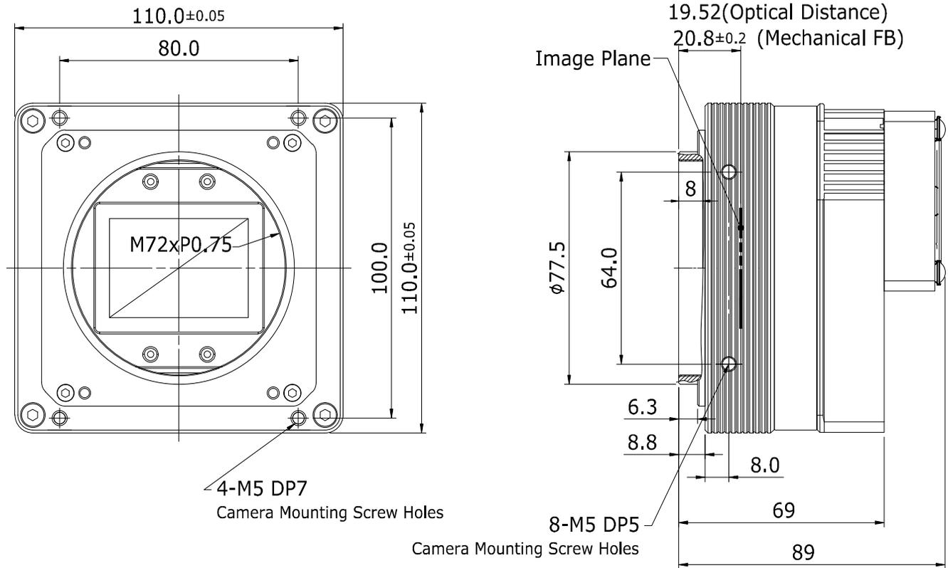
그림 5-4 Mechanical Dimension for VP-127MC-M/C6H
