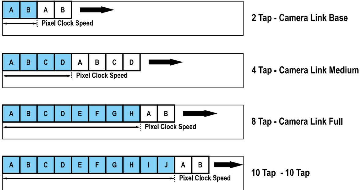
그림 9-6 Camera Link Tap Geometry
