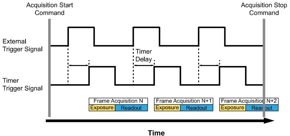
그림 8-3 External Trigger Delay
