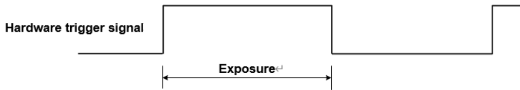
그림 8-28 TriggerWidth 노출 모드의 상승 에지 트리거 시퀀스
