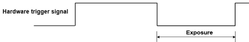
그림 8-29 TriggerWidth 노출 모드의 하강 에지 트리거 시퀀스
