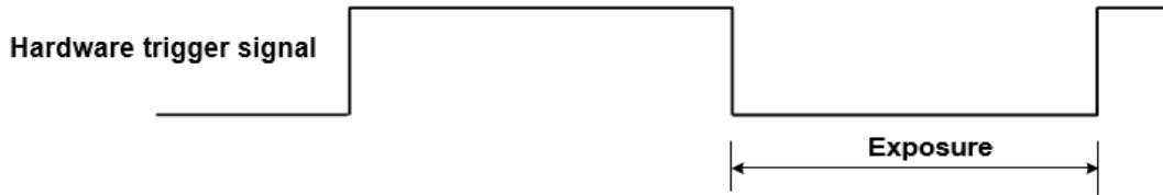
그림 8-30 TriggerWidth 노출 모드 of 하강 에지 트리거 시퀀스
