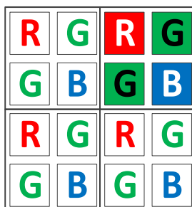
그림 8-49 Horizontal and vertical color Binning (2×2)
