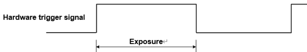
그림 8-29 TriggerWidth 노출 모드의 상승 에지 트리거 시퀀스
